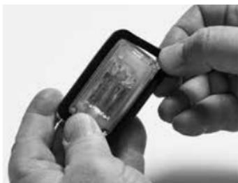
3. Gummidichtung vom Modul abnehmen und am neuen Modul anbringen
