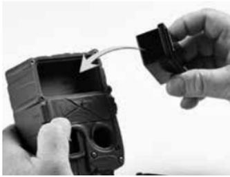
4. Modul in die Kamera einlegen (passt nur in eine Richtung)
