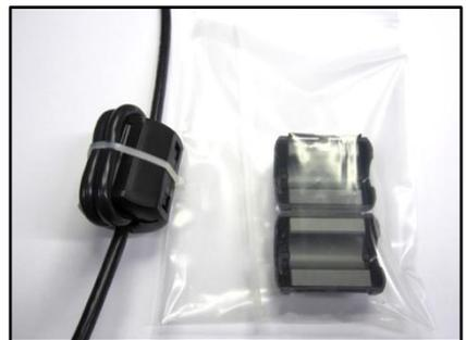
2. Faire plusieurs boucles avec le câble à travers la ferrite et fermer cette dernière. Une attache autobloquante est incluse pour mieux sécuriser la ferrite. L'image montre la ferrite telle qu'elle est expédiée (à droite) et une fois installée (à gauche).
