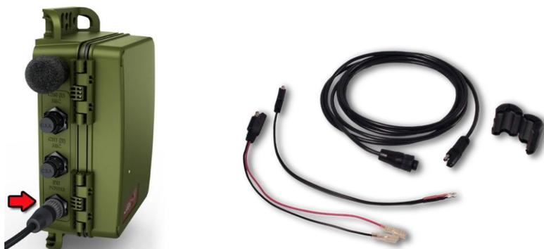
4. Le câble d'alimentation externe comprend des cosses rectangulaires de taille F2 et des cosses à œillet. Connecter le câble à une batterie de 6 ou 12 volts à l'aide d'un des connecteurs fournis. Le SM4 comporte une protection contre les inversions de polarité accidentelles.
