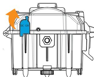
La caméra peut également être alimentée au moyen d'une source externe de 12 volts telle qu'une batterie 12V (KIT-12V, BATT-12V ou KIT6V/12V), ou un adaptateur 12V (AD-12V), tous vendus séparément.
