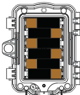
La caméra requiert l'utilisation de 6 piles AA (1,5V). L'emploi de piles alcalines ou au lithium est fortement recommandé. La polarité des piles doit être respectée.
