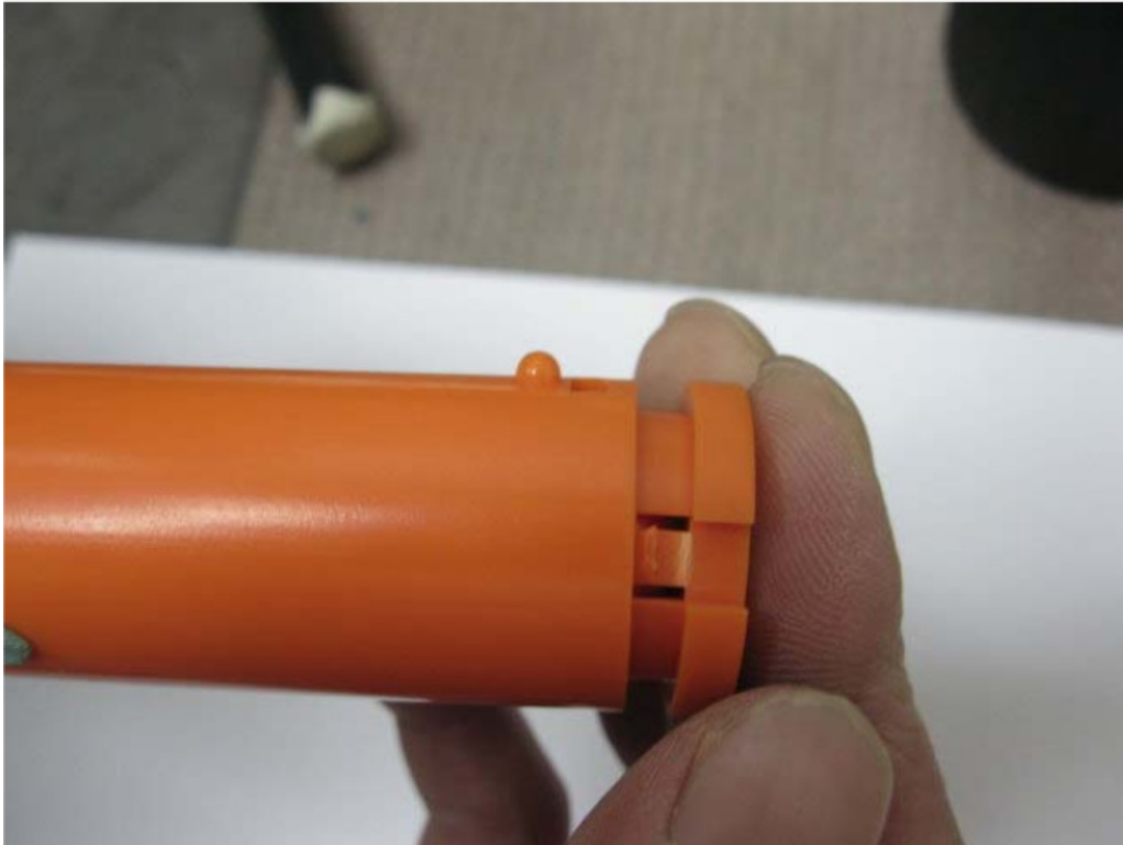
7. CO 2 -Gasflasche mit Deckel verschliessen
