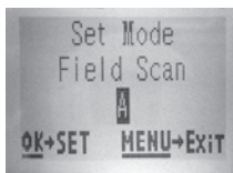
(Schritt 2)- Field Scan A wählen (OK drücken)
